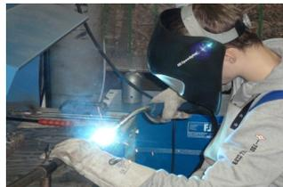
Verbinden der Bauteile durch MAG-Schweißen
